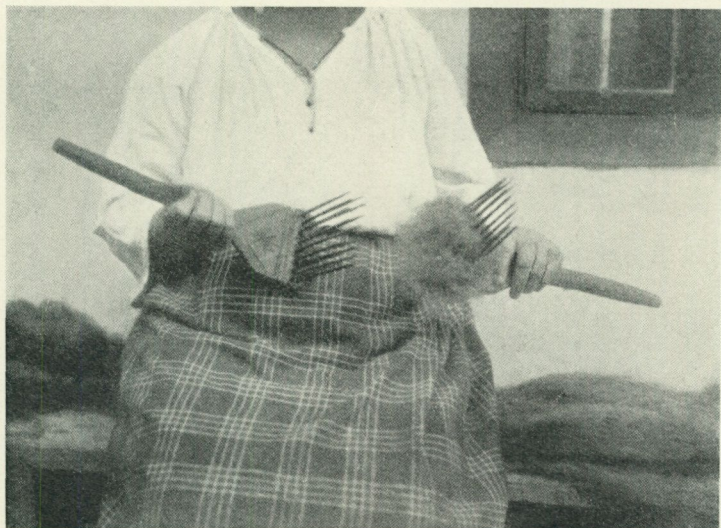
Fig. 22. Kamning av ull med ett par ullkammar. Rumänien. Efter Tache Papahagi.
