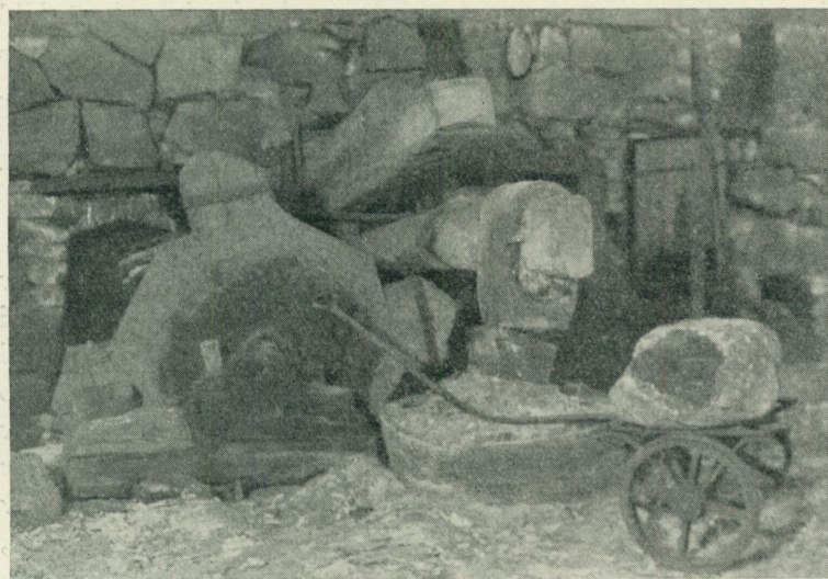
Fig. 13. Räckhammare i Skogaholms stångjärnsmedja. Till höger om städet en kärra med Franche-Comtésmälta. Foto John Hellquist 1930.
