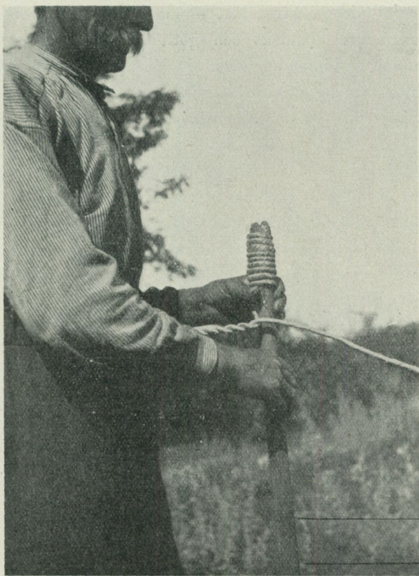
Fig. 2. Petter Simonsson i Byxelkrok lägger hop talltåten till två tåtar. b och a = kavelns sträng- och tögmärke. Foto förf. 1927.
