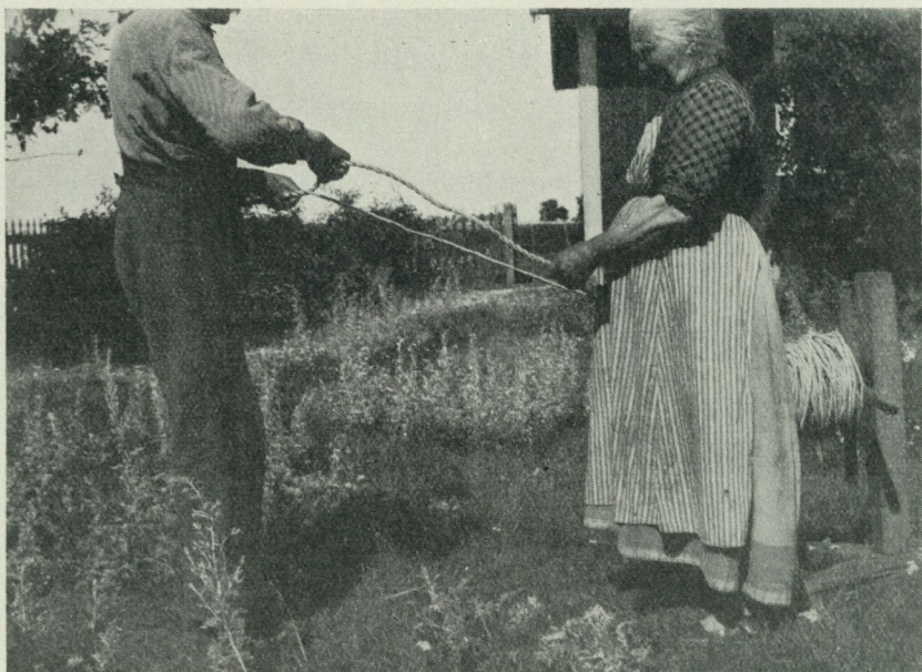
Fig. 3. »Lägga tretätt.» Tvefällingen (i gummans hand) lägges över den enkla tät, som sträcket från reptrollan. Jfr fig. 26. Foto förf. 1927.
