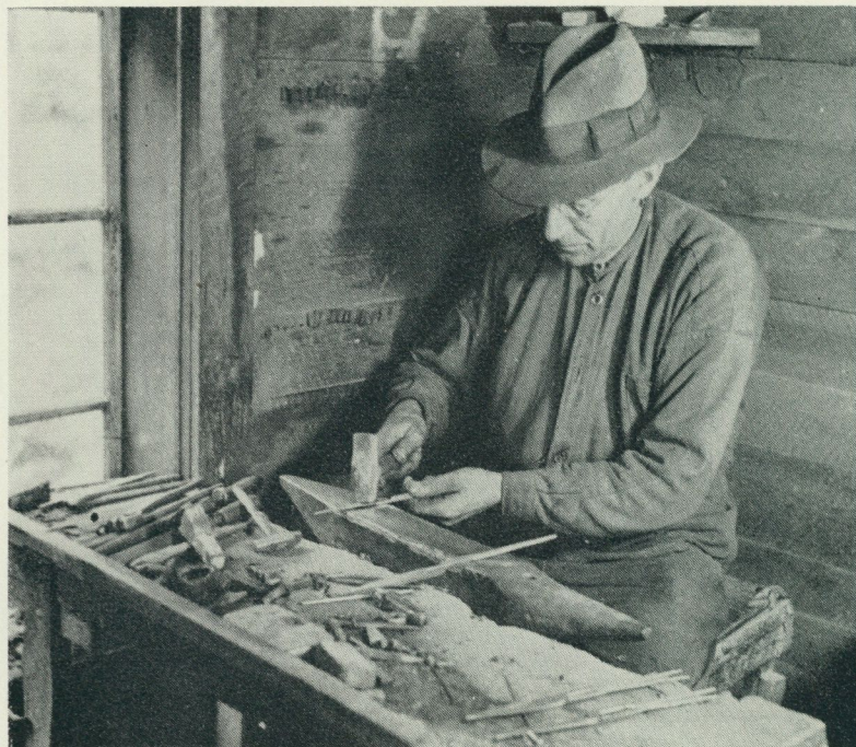
Saxsmeden Ernst Lindkvist vid arbetsbänken i sliperiet. Saxbladet riktas. Foto författaren 1943.
