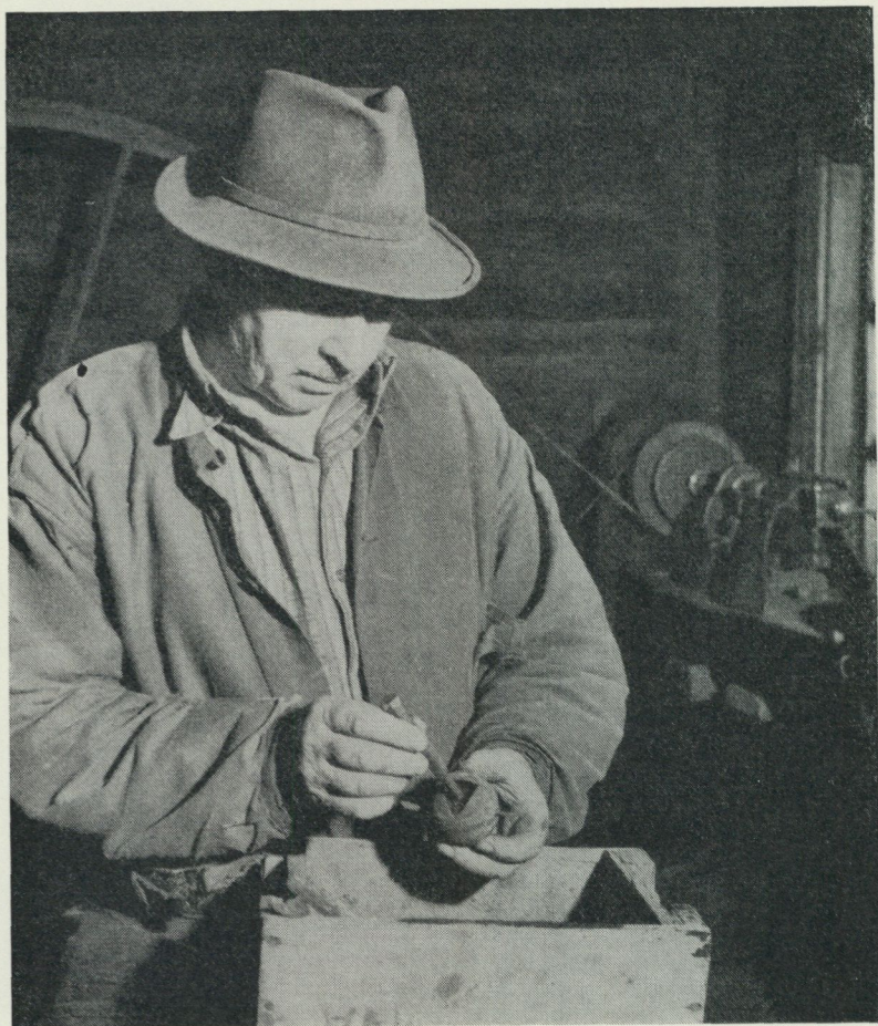
Gelbgjutaren Enoch Johnsson, som drivit verkstaden till 1946, visar hur man gör kärnor till dombjällror.
