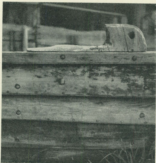
Fig. 9. Tränaglar fasthålla spanten på denna båt från Edskö, Hille socken, Gästrikland. Märk också det typiska årläget, en »hå» av gammaldags byggnadssätt. Foto Nordiska museet 1931.
