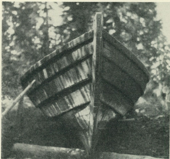
Fig. 10. Höga och branta resa sig båtens bord, särskilt de två nedersta, de s. k. vindorna, på denna snipa från Gåsholma på Gästriklandskusten.
