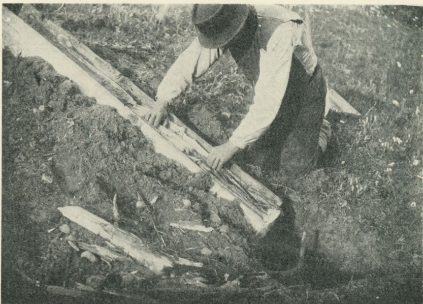
Fig. 5. Tjärtrumma, som fylles med töre.
