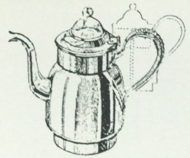
Kaffebruggare Nr 4 U 24050, av polerad aluminium, locket med glasisättning och handtaget lindat med rotting. Med insats och särskild kaffebehållare, som i botten är försedd med små hål. Då vattnet bränts till kokning stiger det upp genom ett rör och gjutes över och sjunker genom kaffepulvret samt cirkulerar på detta sätt så länge kokningen varar. Rymmer 1½ liter men kokar vilket mindre kvantum som helst. Pr st. Kr. 6.85
