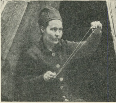
Fig. 5. Tråden nystas kring högra handloven för kontroll av sladdarnas samsning och för avlägsnande av möjligen befintliga knutar och snälör.
