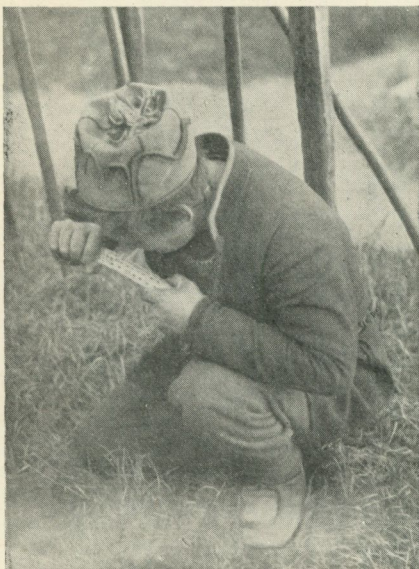
Fig. 9. Lapp dragande tenntråd med tänderna genom en hornskiwa.
