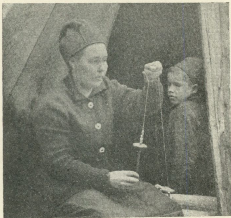
Fig. 12. En tenstråd och en sentråd hop-tvinnas medelst snaltie . Bilden tagen i det ögonblick, då snäldan förmedelst fingrarna sättes i roterande rörelse.
