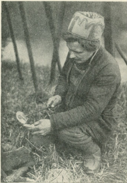
Fig. 17. Bältsmyckegjutning. Det smälta tennet hälls ur stöpsleven i gjutformen.
